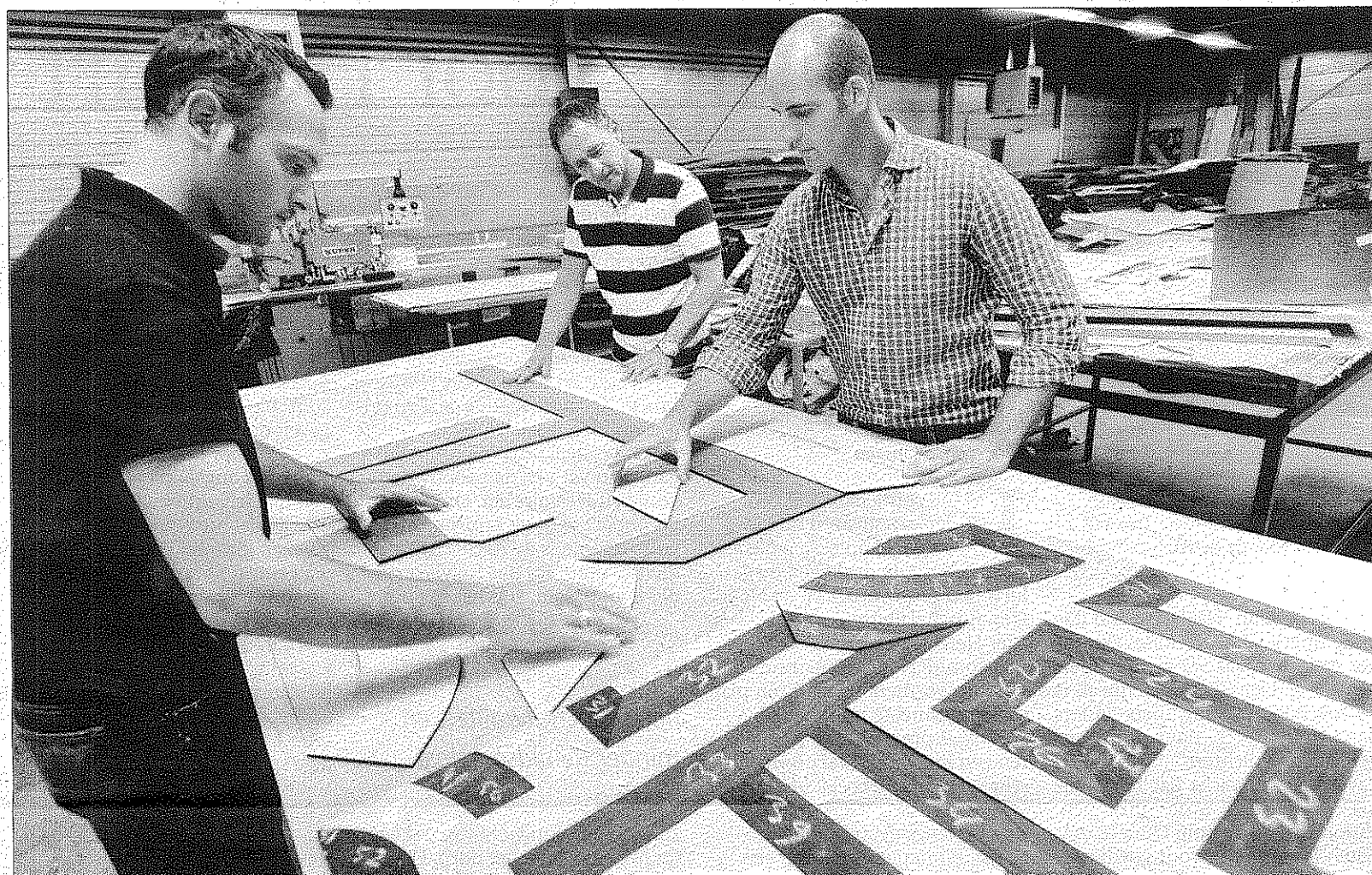
Achter de tafel in de bedrijfshal van Finemarq zijn Harrie Spijkers (links) en Rob Verhoeven bezig de door het laserapparaat uitgesneden onderdeeljes van blank en door en door gerookt eikenhout op een paneel te leggen. Werknemer Jorik van Boxel (op de voorgrond) helpt mee. foto Joris Buijs/PVE
